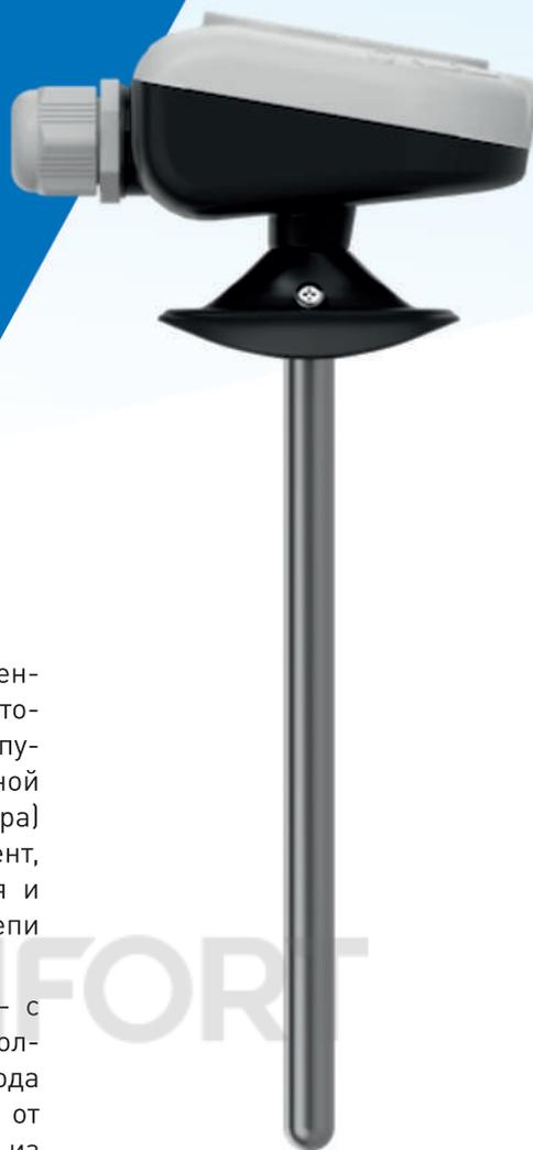
Термостат защиты электрокалорифера от перегрева одноступенчатый TS-K02-90 конструктивно состоит из защитной гильзы, в которую помещен биметаллический термостат в изолированном корпусе. В случае изменения температуры в канале вентиляционной системы (между нагревательных элементов электрокалорифера) происходит нагрев гильзы и измерительного элемента. В момент, когда температура превышает уставку, контакты размыкаются и выдают сигнал на систему автоматизации или размыкают цепи управления нагрузкой.
