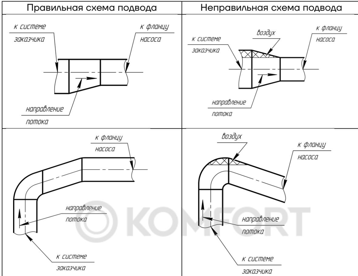
Рис. 7 Схемы подвода
