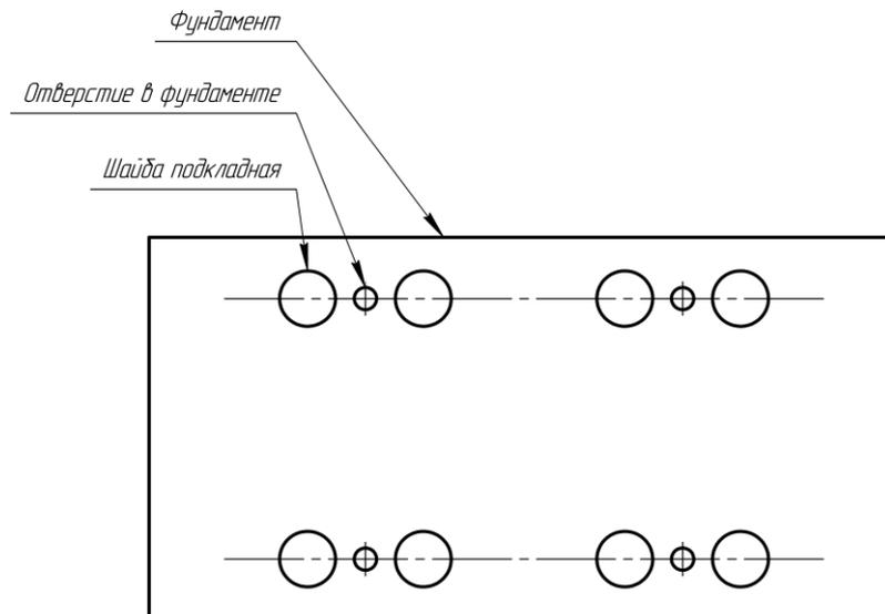
Рис. 5 Схема расположения шайб на фундаменте (вид сверху)
