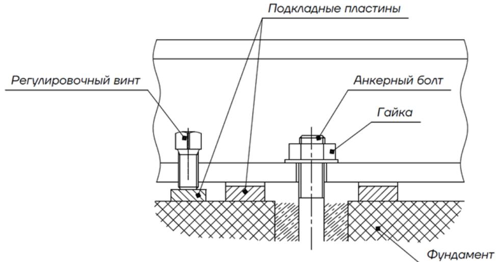
Рис. 6 Схема расположения шайб на фундаменте (вид сверху)
