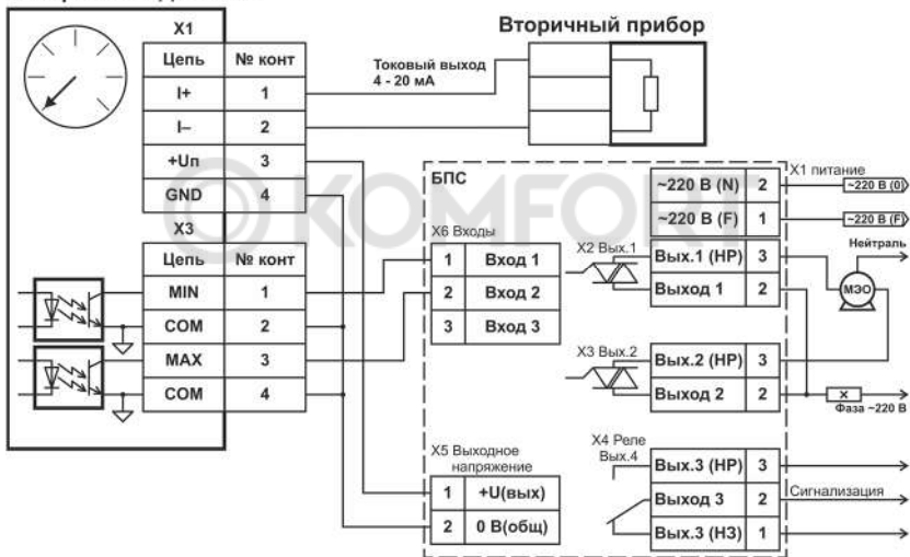
Рис. 5. Схема подключения АДМ-100.4 к БПС-24
