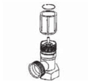
2) Полностью отвинтите регулирующую ручку
