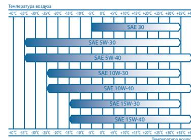
При температуре воздуха выше +5°C рекомендуется применять масло SAE30. При температуре воздуха ниже +5°C рекомендуется применять масло SAE 5W30 (SAE 10W40). Допускается применение масла других производителей, соответствующего категории SJ и выше по классификации API и соответствующего вязкости по классификации SAE в зависимости от температуры окружающего воздуха.
