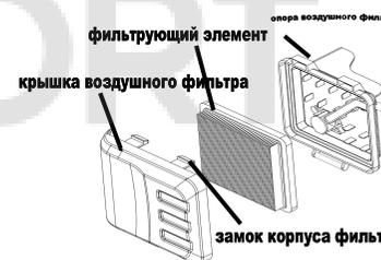
Грязный воздушный фильтр уменьшает поступление воздуха в карбюратор, изменяя соотношение воздушно-топливной смеси. Это приводит к образованию нагара и повреждению двигателя.
