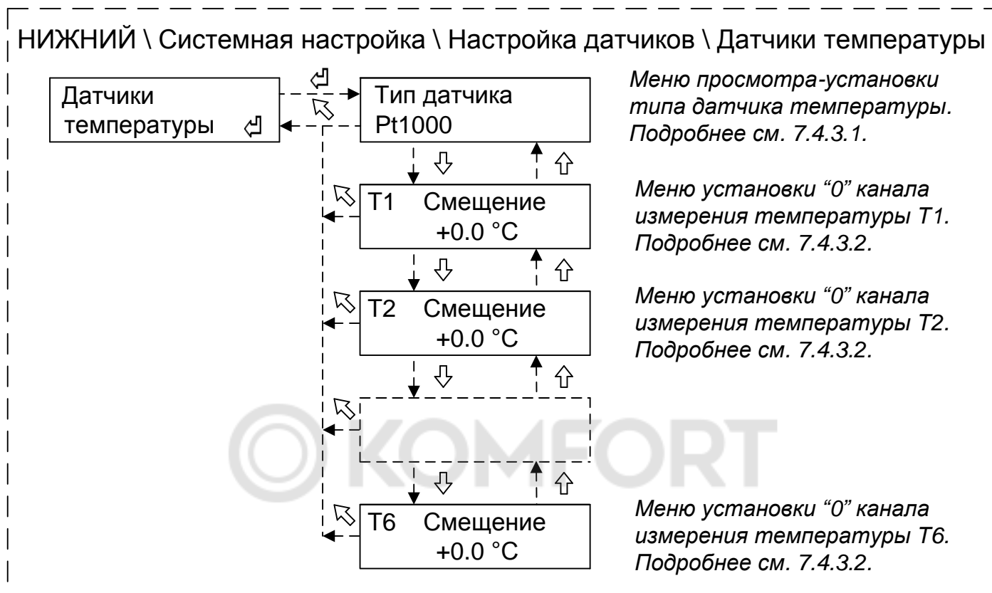
Рисунок 7 – Структура меню настройки датчиков температуры
