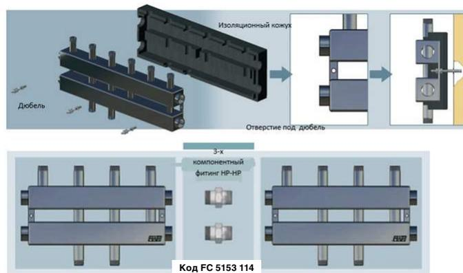
Коллекторы могут собираться до требуемого количества потребителей с помощью трехкомпонентного фитинга с наружными резьбами 1”1/4.
