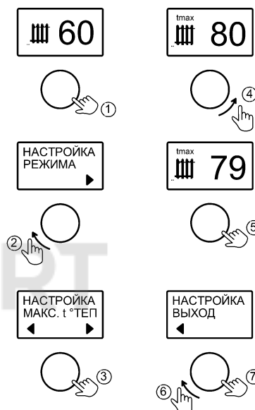
Рисунок 9. Настройка максимальной температуры теплоносителя
