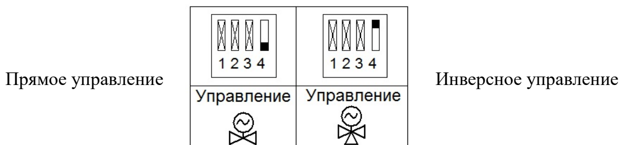
Рисунок 6 - Комбинации положения переключателя SA1.4 при задании направления управления
