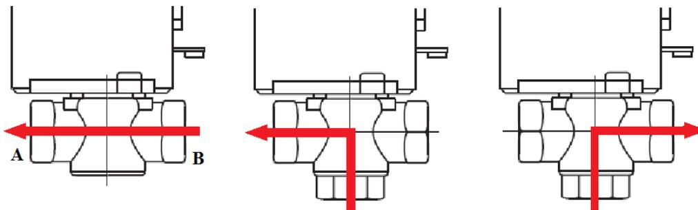
При установке 2-ходового клапана конец В предназначен для поступления воды (под клапаном отмечены А и В).
