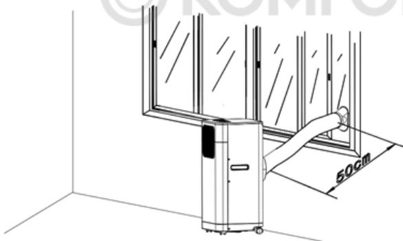
1. Прибор устанавливается на ровную напольную поверхность;
