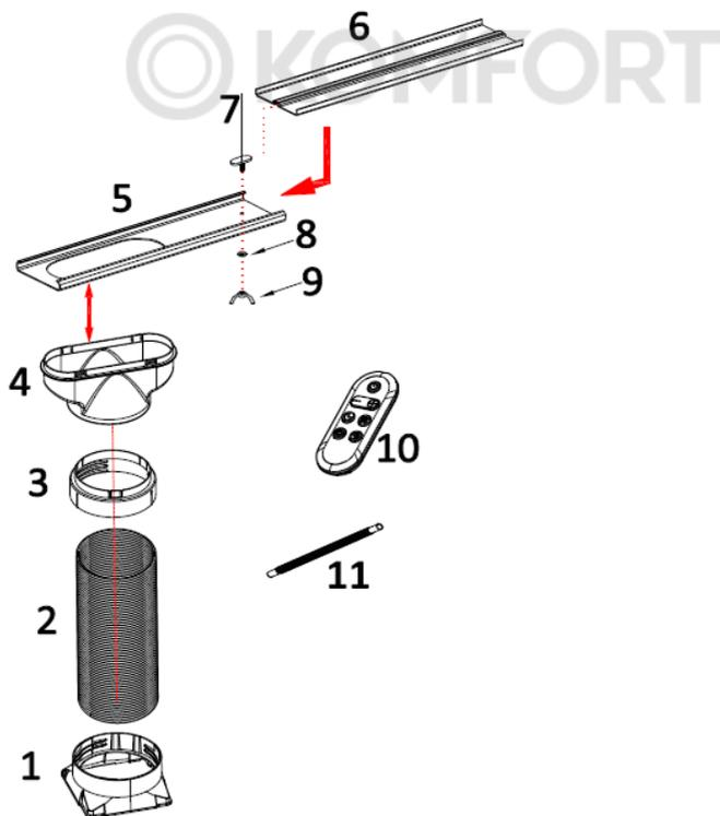
1. Адаптер для соединения прибора с воздуховодом
