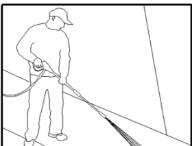
Рис. 6. Оптимальный угол относительно очищаемой поверхности
