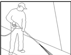
Рис. 6. Оптимальный угол относительно очищаемой поверхности
