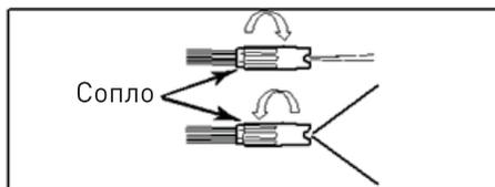
Рис. 2. Регулировка распыления сопла (недоступна для некоторых сопел)
