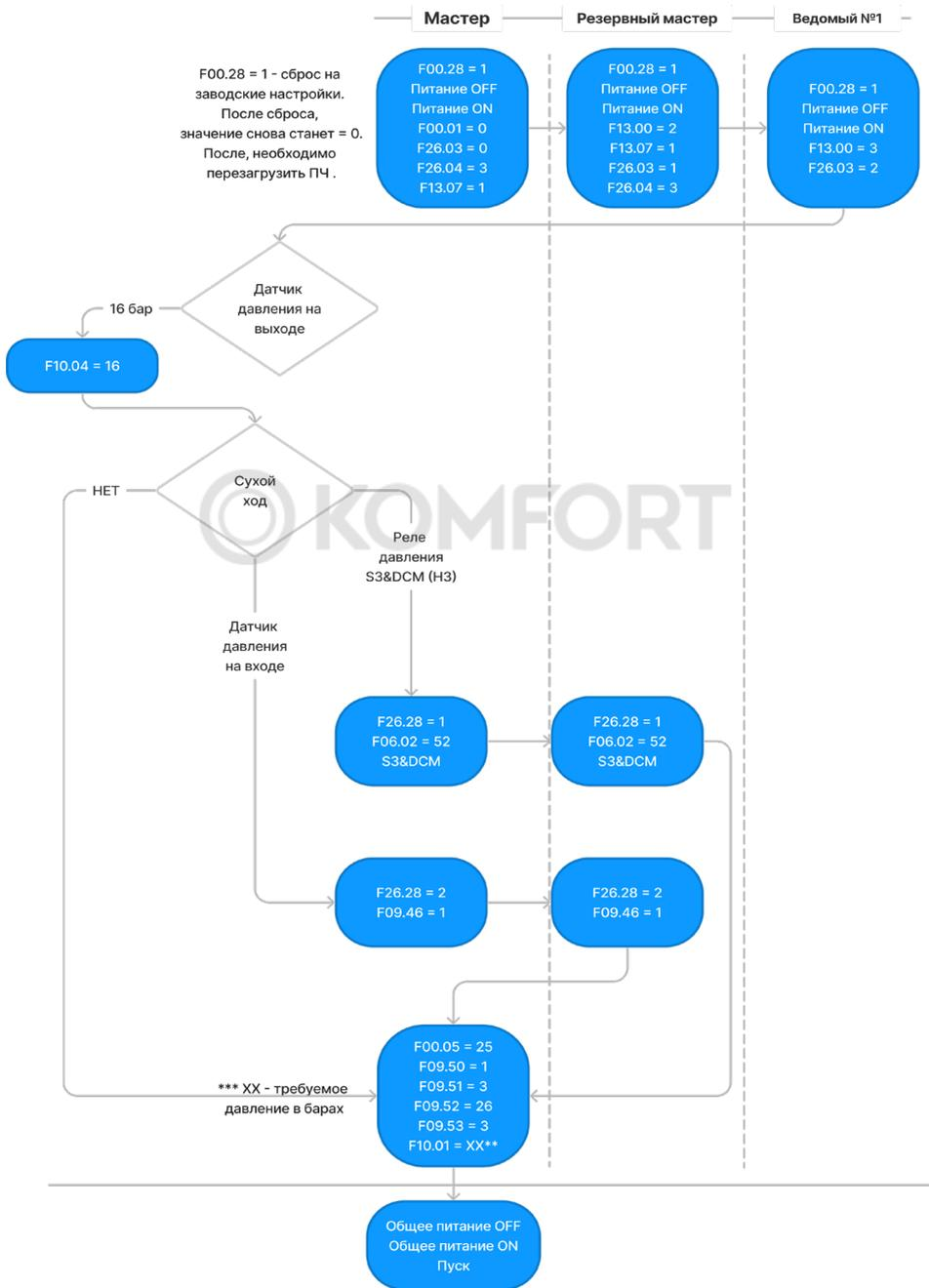
Рис. 13 Пример настройки 3-х насосной станции
