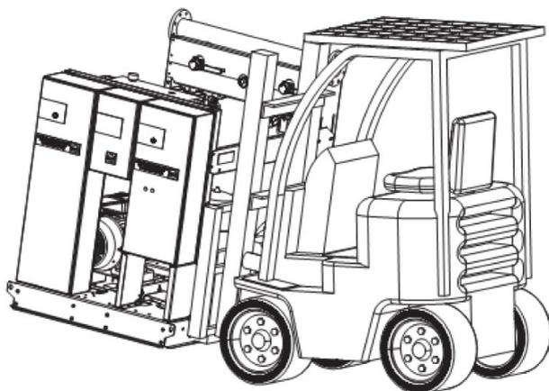
Рис. 3 Схема перемещения УПД к месту монтажа
