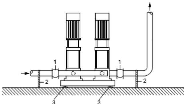
1 – Компенсатор, 2 – опоры трубопровода, 3 -вибрационная опора
