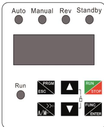
Рис. 7 Панель управления контроллера PD ES IP65
