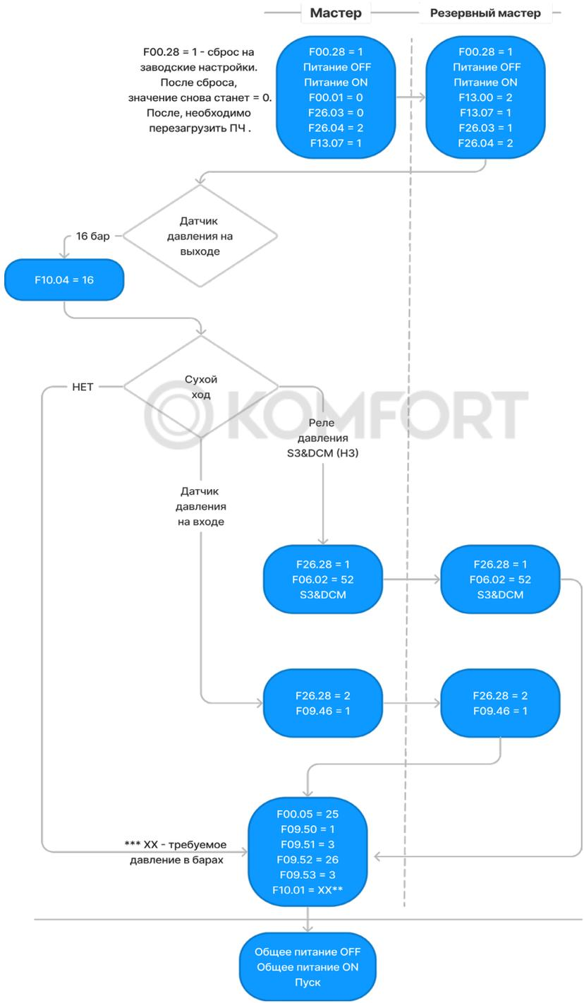
Рис. 12 Пример настройки 2-х насосной станции
