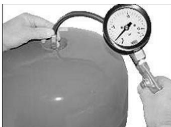
Рис. 6 Контроль давления в мембранном баке
