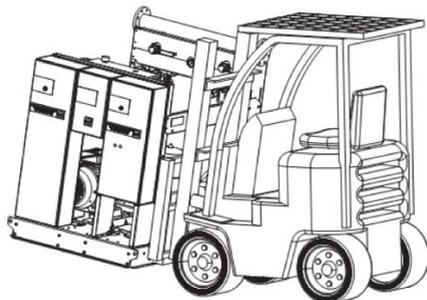
Рис. 3 Схема перемещения НУП к месту монтажа
