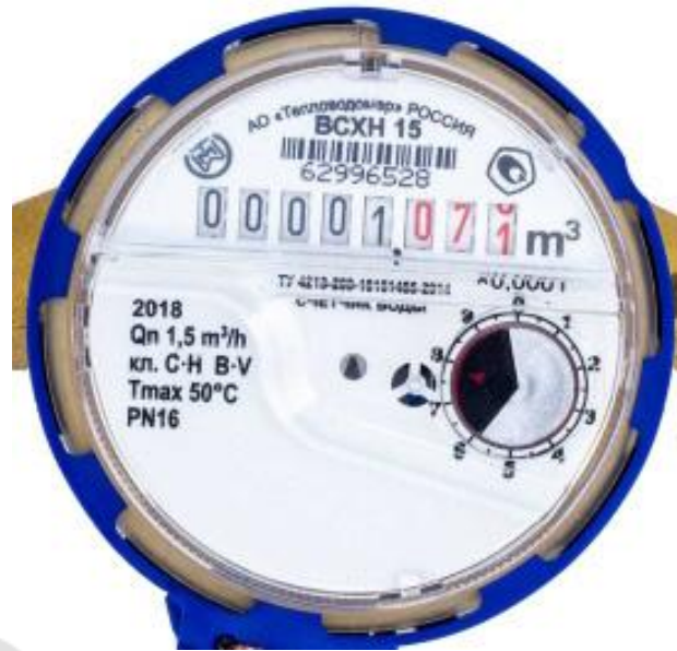
Рисунок 1. Счётный механизм счётчика BCXH-15
