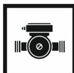
Защита насоса и трёхходового клапана от закисания. Включение раз в сутки для предохранения его внутренних частей от образования отложений кальция и пр.
