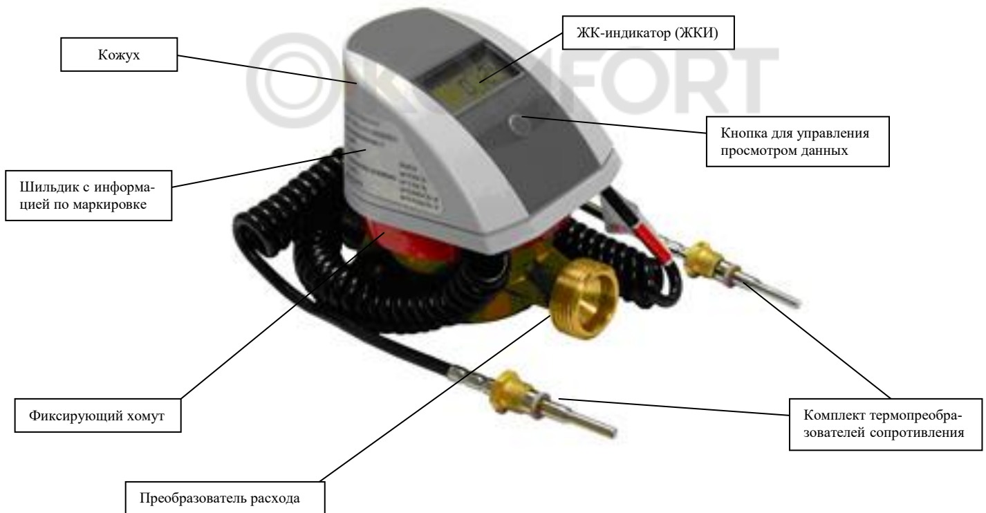
Рисунок 2. Внешний вид и состав теплосчётчика ELF-M
