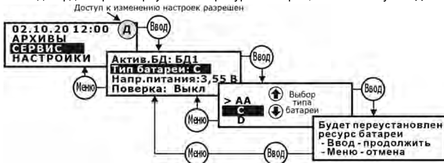
Рис.И.2 – Порядок установки/выбора типа батареи
