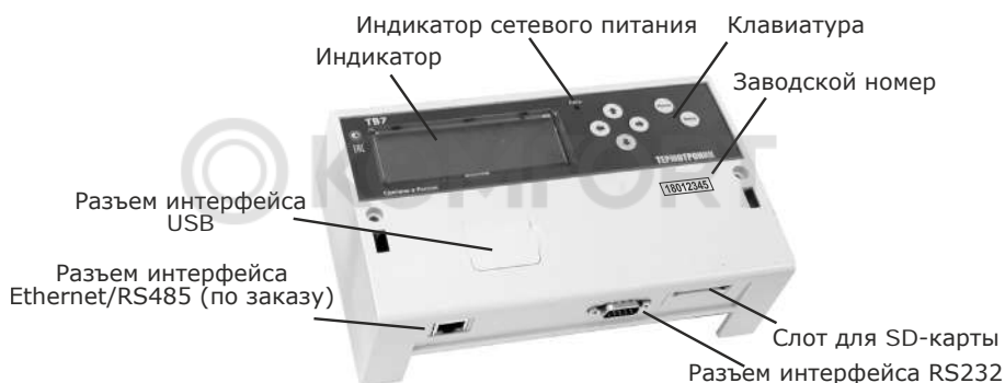
Рис. 2.1 – Внешний вид приборного отсека ТВ7 (вид сверху)
