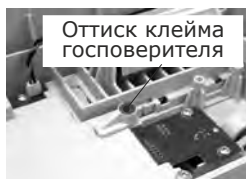
Рис. 1.2– Места пломбирования вычислителя
