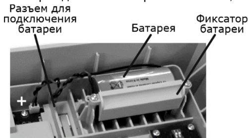
Рис.И.1 – Крепление батареи
