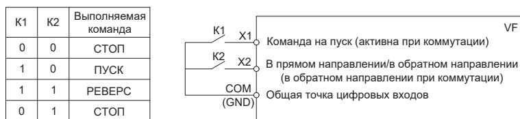
Рисунок 10.9-6. Двухпроводная схема управления 2
