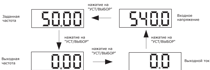
Рисунок 5.5-2. Переключение контролируемых параметров
