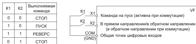
Рисунок 10.9-6. Двухпроводная схема управления 2
