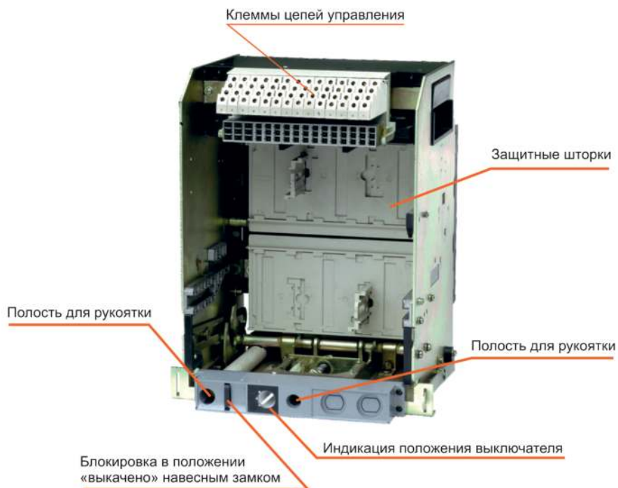
Рисунок 1.2 – Корзина выключателя YON AD-S1; S5; S6
