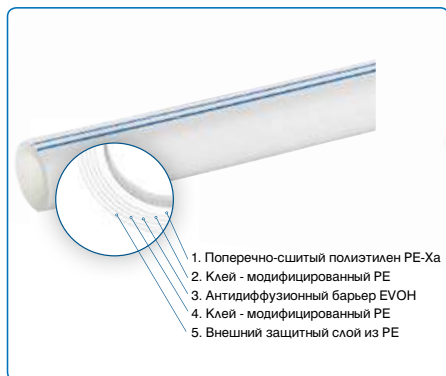
Структура трубы Uponor Comfort Pipe PLUS
