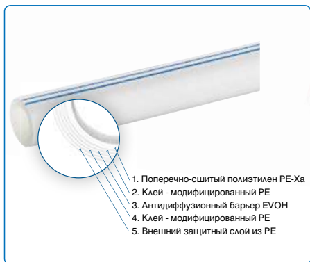
Структура трубы Uponor Comfort Pipe PLUS
