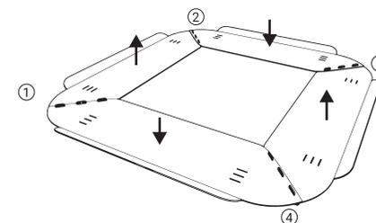
4. Для крепления есть три отверстия. **Используйте отверстия посередине**, вставьте в них крепления. Установите по два крепления в каждое крыло.
