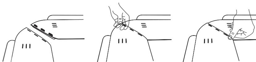
Вставьте крайний фиксатор ребра в крайнее отверстие крыла. Прощёлкните до упора оставшиеся фиксаторы в оставшиеся отверстия крыла.
