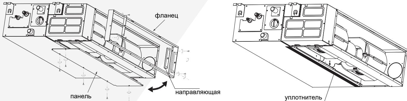
Для смены направления воздушного потока необходимо снять фланец, снять защитную крышку с нижней части внутреннего блока и поменять их местами.
