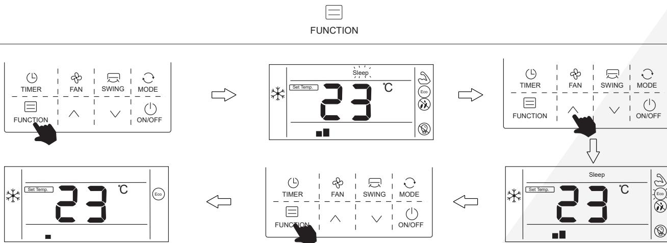
Список функций отображается в правом столбце на дисплее пульта управления и выбирается нажатием кнопок  $\blacktriangle$  и  $\blacktriangledown$ . Часть функций может быть недоступна в вашем оборудовании.
