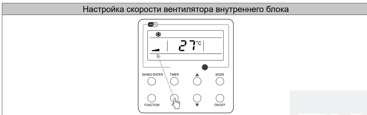
Когда кондиционер включен, нажмите кнопку FAN и скорость вентилятора будет изменяться по следующему алгоритму:
