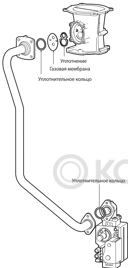
Рисунок 5-2. Газовый узел в разобранном виде (NCB 700-35K)
