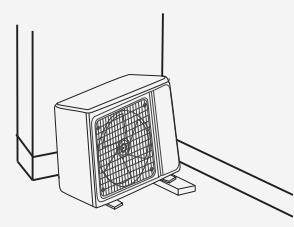
**Правильное расположение наружных блоков при монтаже**
