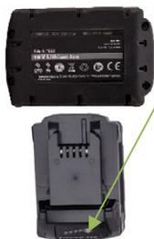
Уровень заряда можно проверить, нажимая на соответствующую кнопку на аккумуляторе. Аккумулятор может оставаться в пресс-инструменте, но инструмент должен быть выключен. Количество освещенных светодиодов показывает уровень заряда. Мерцающий индикатор указывает резерв, не более чем на 10% уровня заряда. Цель этой диагностики - приблизительное определение уровня заряда или резерва аккумулятора.
