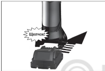
Установите аккумулятор на пресс-инструмент до характерного щелчка зажима защитной блокировки
