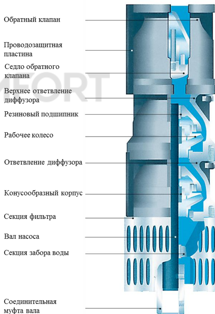
Рисунок 13. Структура насосной части погружного агрегата насосного SM
