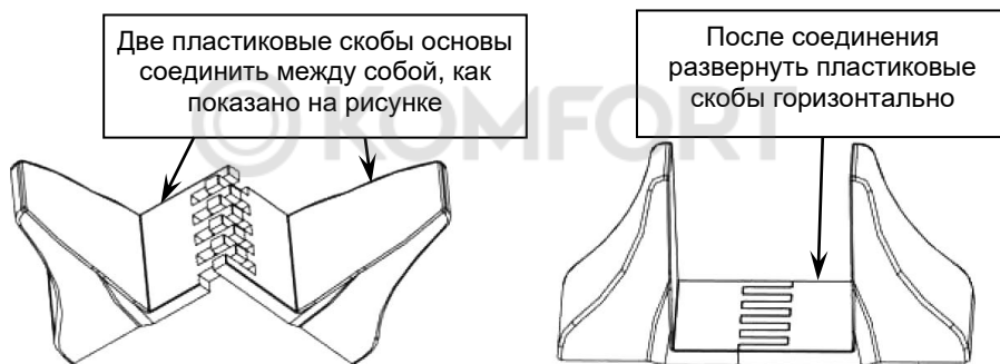
Рисунок 4 - Сборка пластиковых основ для вертикальной установки изделия.
