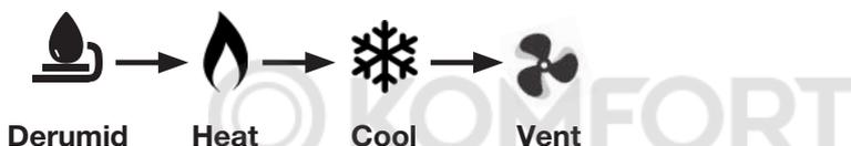
Термостат W-therm 630, W-therm 610 имеет четыре режима работы: Осушение, Отопление, Охлаждение, Вентиляция
