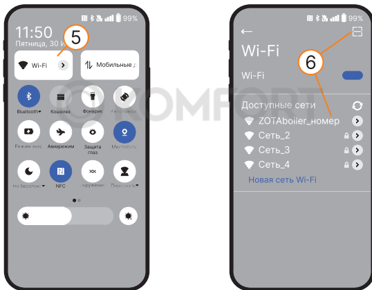
Рис.13 Подключение к сети WiFi «ZOTAboiler»
