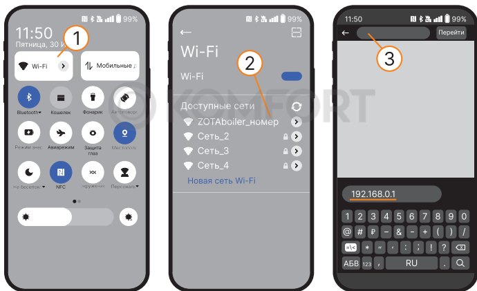
Рис.9 Подключение к сети WiFi «ZOTAboiler», ввод адреса для перехода на WEB-страницу настройки подключения
