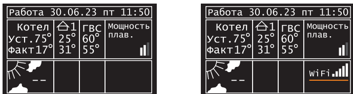
Рис.19 Проверка подключения котла к Вашей сети WiFi
