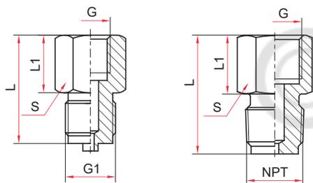
Размеры переходников с внутренней/наружной резьбой (мм)
