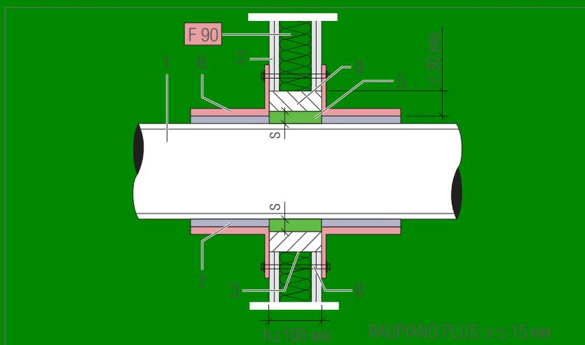
**Установка в несущую перегородку F 90 колонковое бурение**
