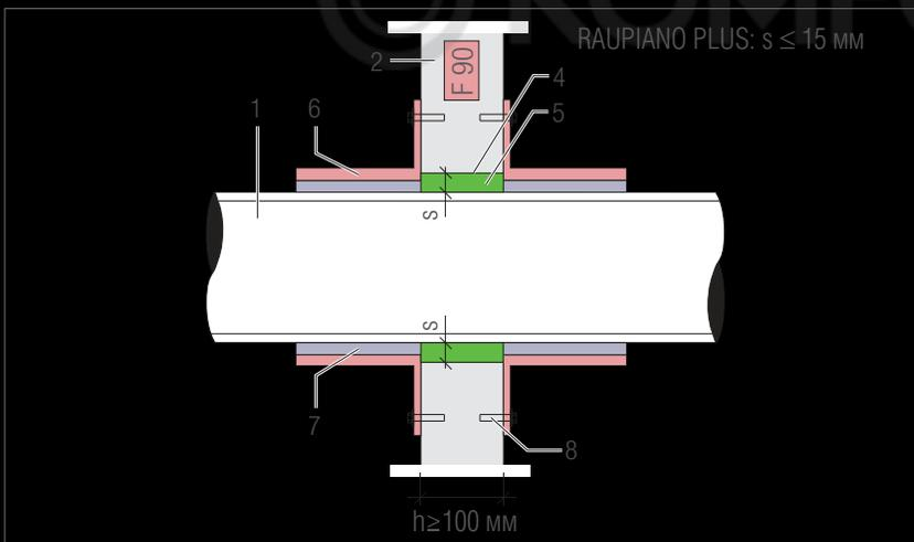
Установка в монолитную стену F 90, отверстие в стене / прорезка фрезой
