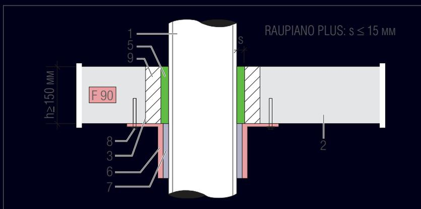
Конструкция в монолитном перекрытии F 90, просверленное отверстие
