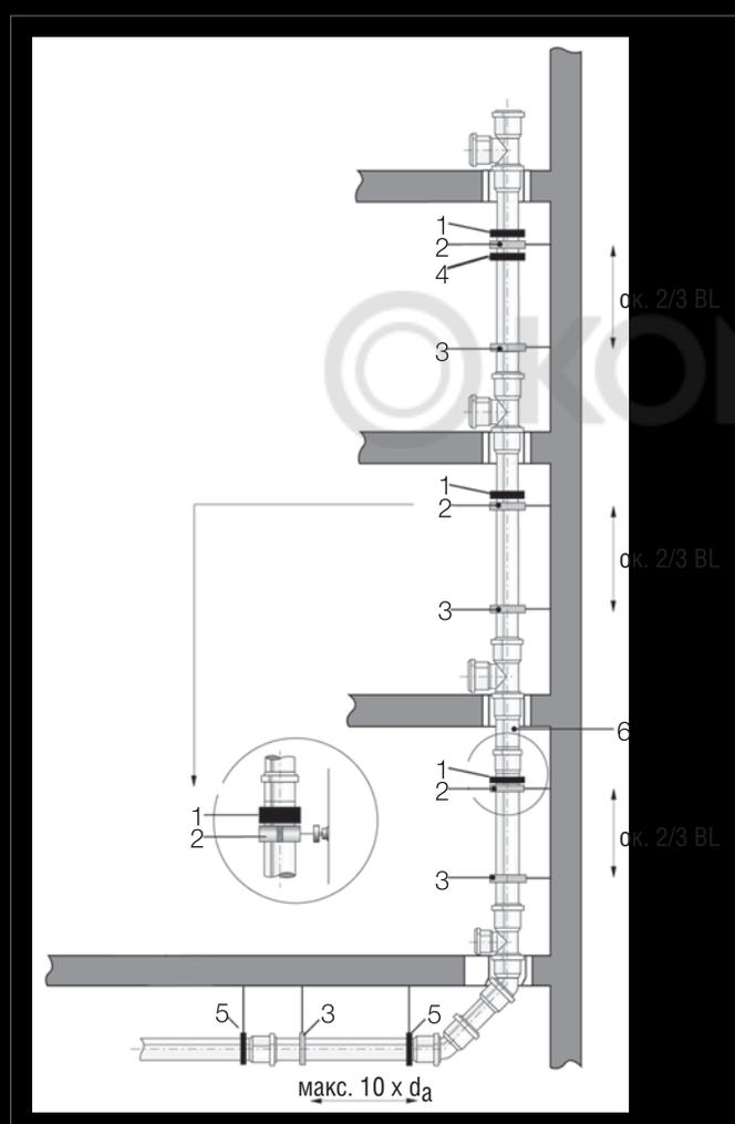
Рис. 8-4 Схема установки стояка
