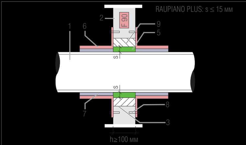
Установка в монолитную стену F 90, колонковое бурение
