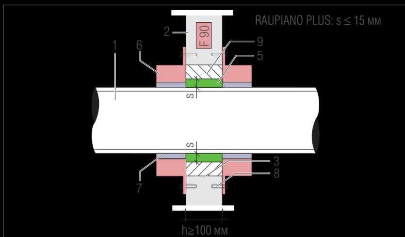
Установка в монолитную стену F 90, бурение фрезой
