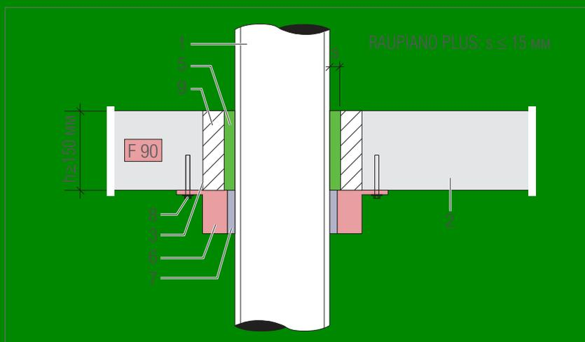
**Установка конструкции в монолитное перекрытие F 90, бурение фрезой**
