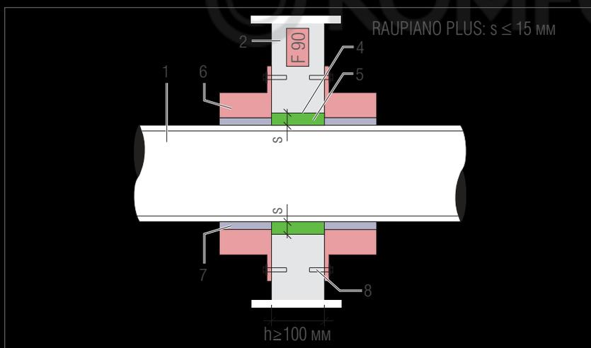
Установка в несущую перегородку F 90, отверстие в стене
