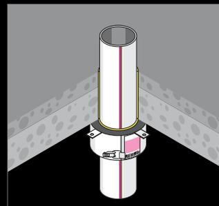
Рис. 5-2 Монтаж противопожарной манжеты на перекрытии
