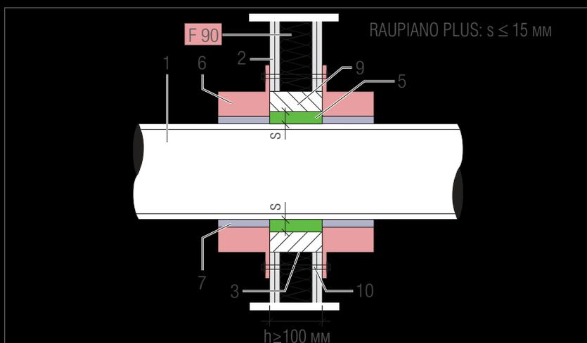
Конструкция стены F90 из гипсокартонных огнеупорных плит согласно DIN 4120-4
