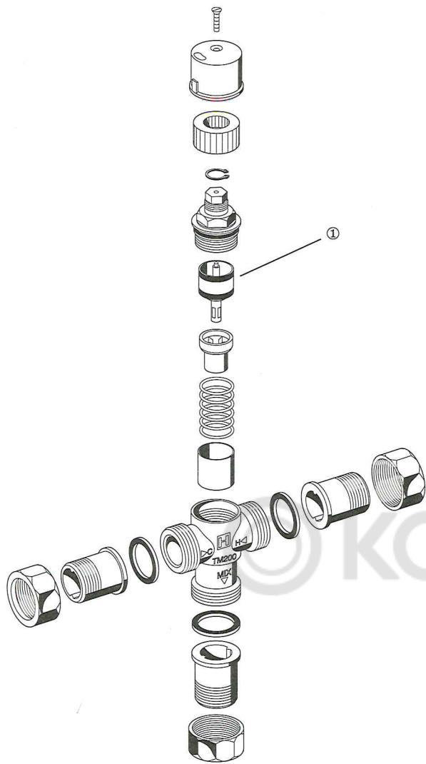
Запасные части для терморегулирующего смесительного клапана горячей воды (начиная с 1996 года)
