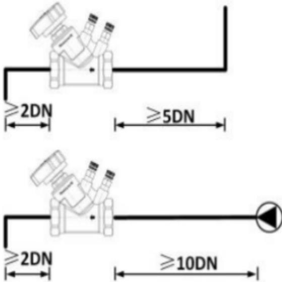
1. При установке клапана статического баланса на обратной трубе, направление потока воды должно соответствовать стрелке направления потока на корпусе клапана.
