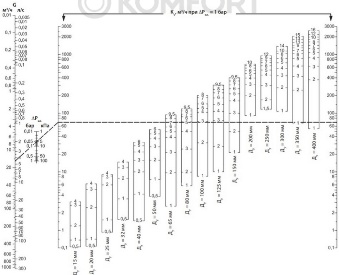
Также можно установить заданное значение регулировки клапана посредством использования пошаговой регулировки через значение пропускной способности.
