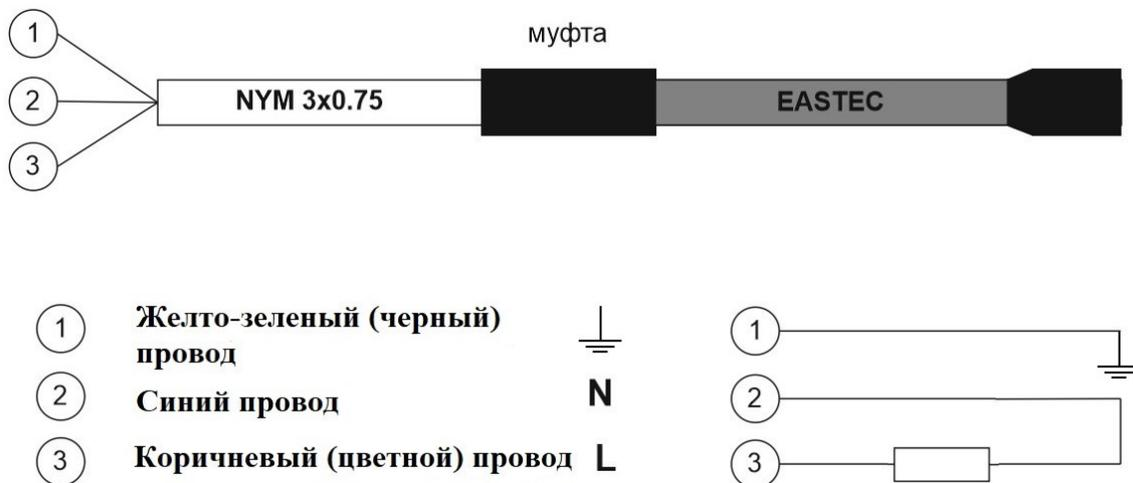
Рис. 1. Схема подключения.
