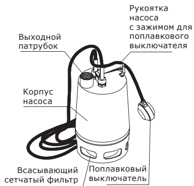
Рис. 1 Конструкция насосов APV.06 / APV.40 V
