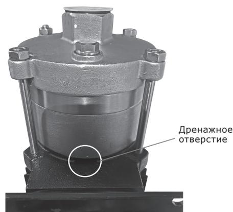
**Рис. 11** Дренажное отверстие торцевого уплотнения
