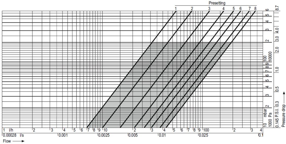
Примечание: Рекомендуемый диапазон для применения с приводом типа МТ4, М100, М4410Е1510, М4410К1515 и М7410А1001
