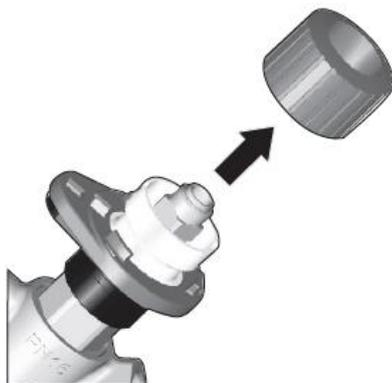
4. Вращением белой настроечной ручки установите клапан на нужное значение настройки, контролируя текущее значение по цифровому индикатору на вставке клапана
