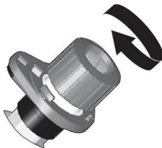
2. При помощи шлицевой отвертки открутите крепежную гайку
