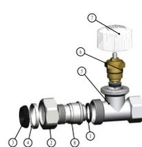
На рисунке представлен прямой термостатический клапан. Конструкция осевого и углового термостатического клапана аналогична
