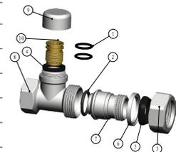
На рисунке представлен прямой запорный клапан. Конструкция углового запорного клапана аналогична.
