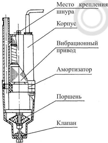
Электронасос (рис. 1) состоит из корпуса и вибрационного привода с поршнем. Нижняя часть корпуса имеет отверстия для забора воды, а патрубок в верхней части служит для её выхода. Вода подаётся через гидравлическую напорную камеру, ограниченную резиновым клапаном и амортизатором, при возвратно-поступательном движении поршня.
