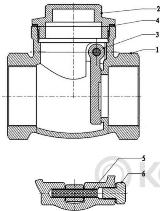
Клапан состоит из латунного корпуса (поз. 1) и крышки (2), в котором расположен подвижный золотник (3), состоящий из латунного штока (5) и фиксатора (6). Соединение крышки с корпусом герметизируется уплотнителем (4).
