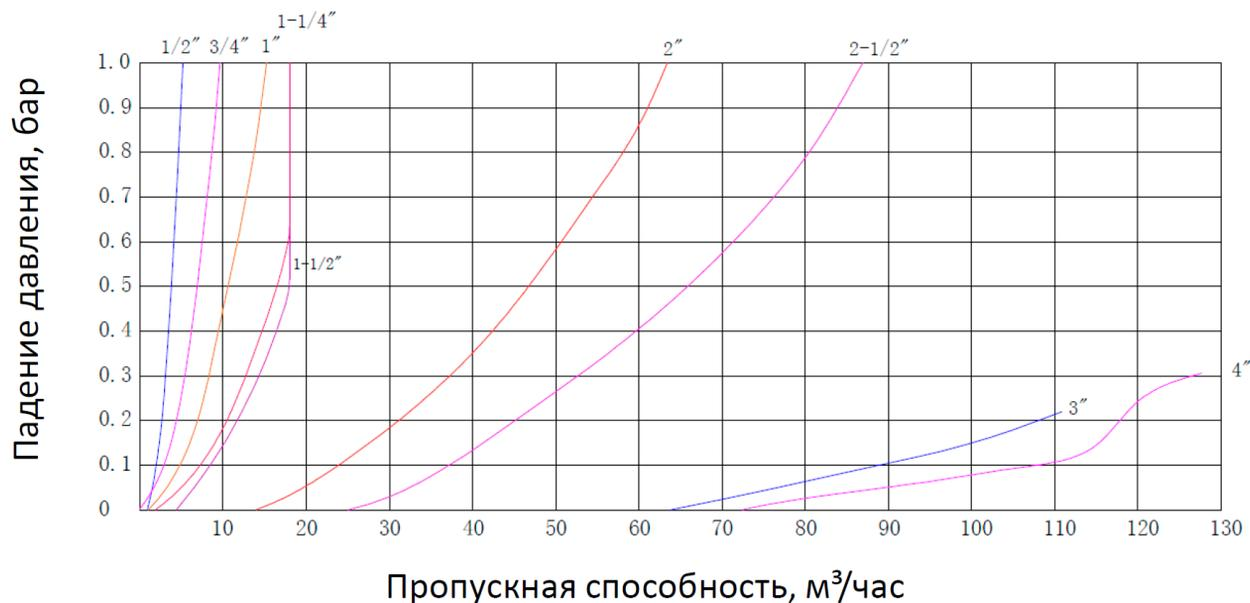
График построен при условиях: рабочая среда – вода; температура воды -23 °С.
