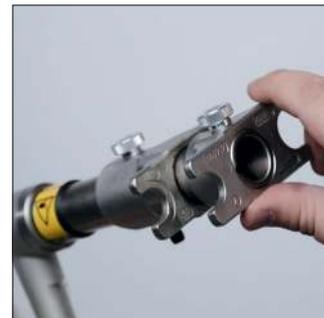
2. Полностью зафиксируйте запрессовочные тиски при помощи крепежных штифтов.
