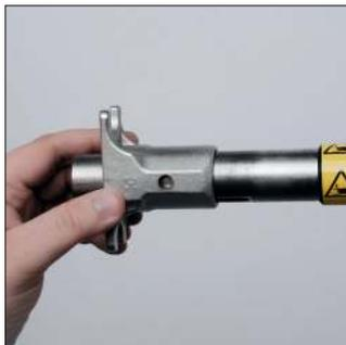
3. Поворотом рабочего цилиндра монтажного инструмента, запрессовочные насадки можно привести в удобное для монтажа положение.
