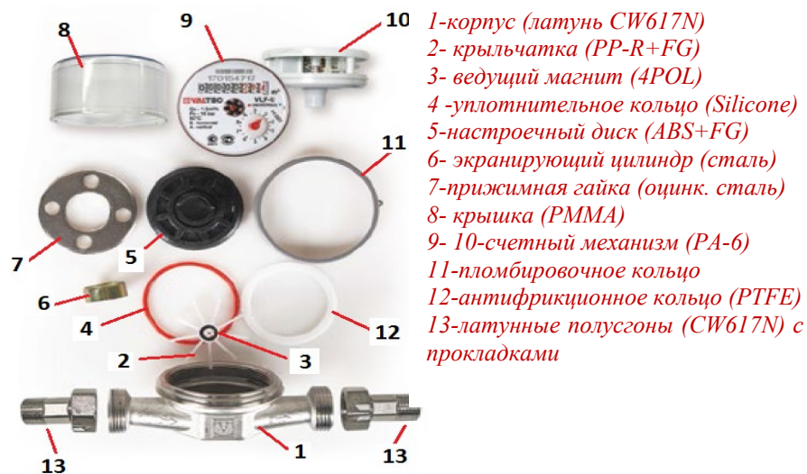
Рис.1 Конструкция счетчика в разобранном виде
