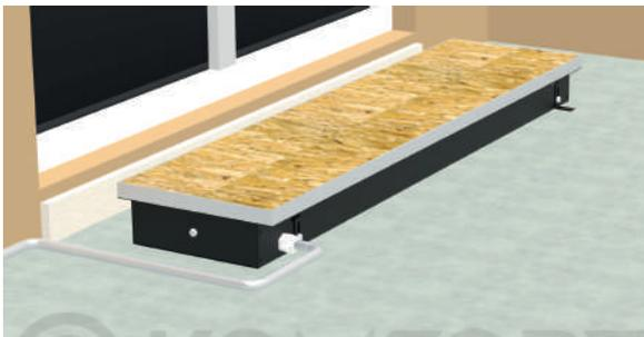
7. Залить бетоном зазоры между стенками отопительного канала и корпусом конвектора;
