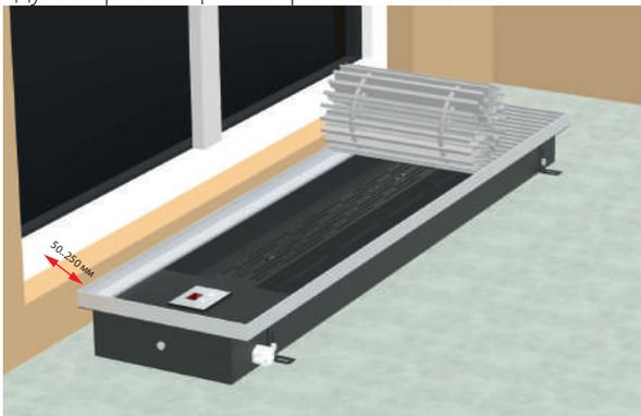
Рекомендуется применять теплоизоляцию отопительного канала между корпусом конвектора и наружной стеной (материал: плита из полистирола толщиной 10-15 мм);
