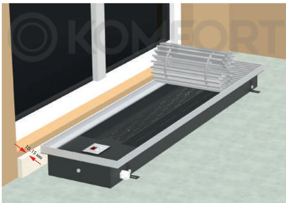
Размеры отопительного канала должны иметь припуск по высоте (Н) +10...15 мм, по длине (L) +100...300 мм и ширине (В) +150 мм по отношению к габаритным размерам конвектора.
