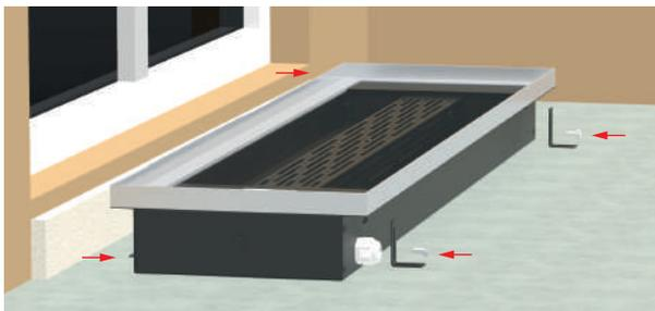
2. Установить конвектор в отопительный канал, после чего закрепить установочные ножки, с помощью дюбелей и крепёжных винтов, к основанию отопительного канала;
