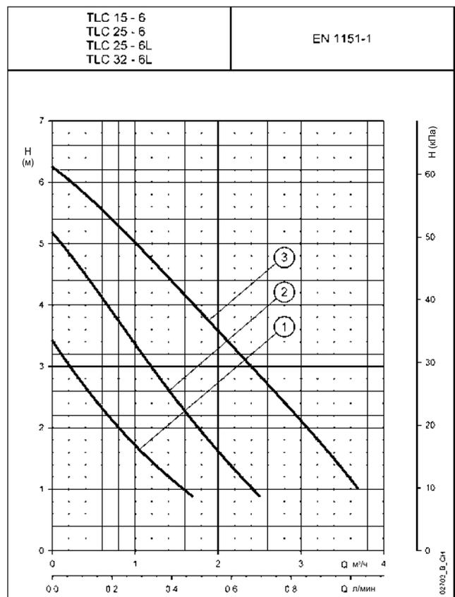
Заявленные характеристики действительны для жидкости с плотностью  $\rho = 1.0 \text{ кг/дм}^3$  и кинематической вязкостью  $\nu = 1 \text{ мм}^2/\text{сек}$ .
