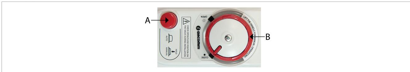
Чтобы запустить привод вручную, удерживайте красную кнопку «А» нажатой и поверните красную ручку «В» в желаемое положение.
